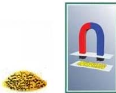
Նկ.1.22 Երկաթի և ծծմբի խառնուրդի բաժանումը մագնիսով
